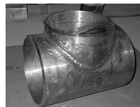
Рис. 2. Тройник паропровода, изготовленный из стали 10X16H4B
